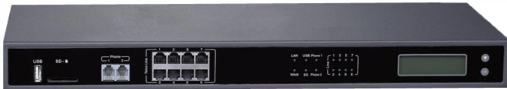
讯美XUC800是北京讯美时代依靠十余年行业经验、资深的技术底蕴结合行业对IPPBX领先特点、性能等自主研发的统一通信SIP服务器，XUC800针对政企办公通信现状，提出突破性统一融合解决方案。集成的8个PSTN主干FXO端口，2个FXS模拟电话端口，支持最多50个SIP中继，同时配备了先进强大的硬件平台和革命性的软件功能，为客户提供一个协同办公、融合会议、无纸传真、移动办公、可视门禁、广播对讲和安全监控等全方位应用要求于一体的突破性解决方案。
